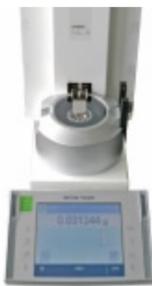
6 stellige Feinwaage für Volumen ab 0,1µl
